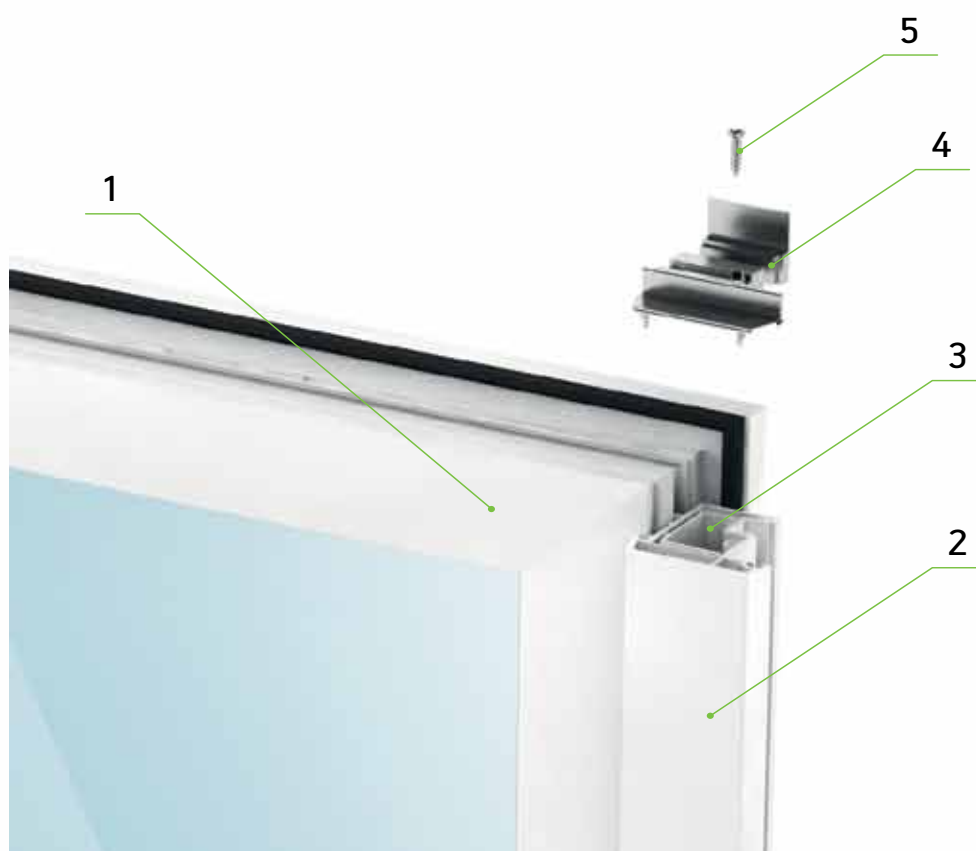
Рис. 22. Схема крепления шульпа к створке.
